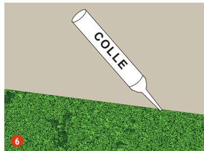
Fixer les bordures du gazon avec le scotch double face ou avec un tube de colle en créant des noisettes espacées tous les 20 cm pour laisser l'eau s'écouler.
